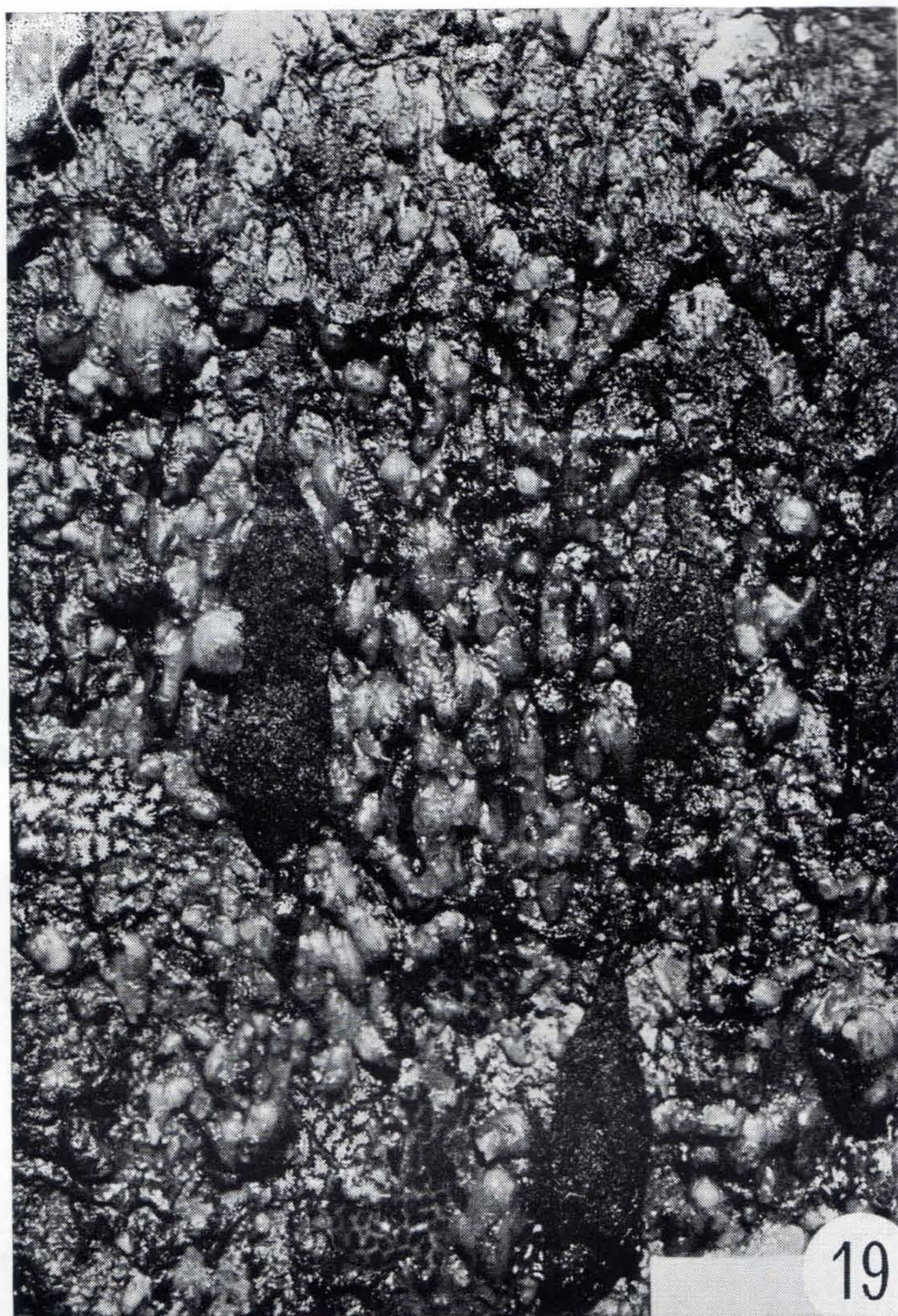
FIG. 19. Pannello immerso allo Y.C.I. per tre mesi e prelevato ad aprile: dominano gli Ascidiacei coloniali e solitari e le Alghe del gen. Enteromorpha .
