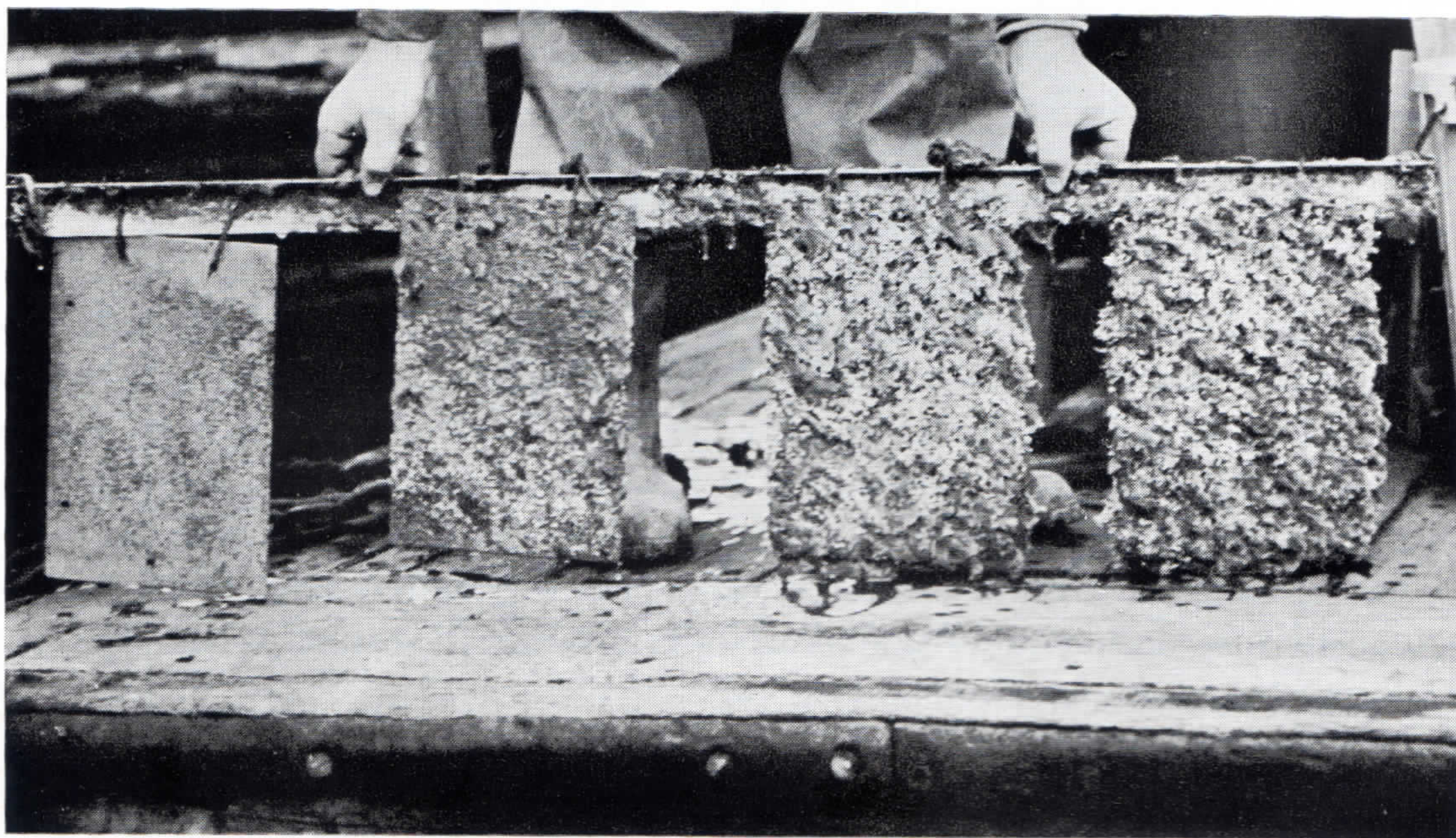
FIG. 9. Gruppo di quattro pannelli che rimasero immersi rispettivamente, iniziando da sinistra, per 1, 3, 6 e 12 mesi. La foto è stata eseguita alla fine di dicembre alla stazione Chiatte. Il primo pannello quindi è rimasto immerso per tutto dicembre; il secondo, immerso durante novembre e dicembre, venne prelevato alla fine di gennaio. Il terzo ed il quarto, immersi dall'inizio dell'esperienza, cioè da luglio, vennero prelevati rispettivamente a gennaio e alla fine delle osservazioni.
