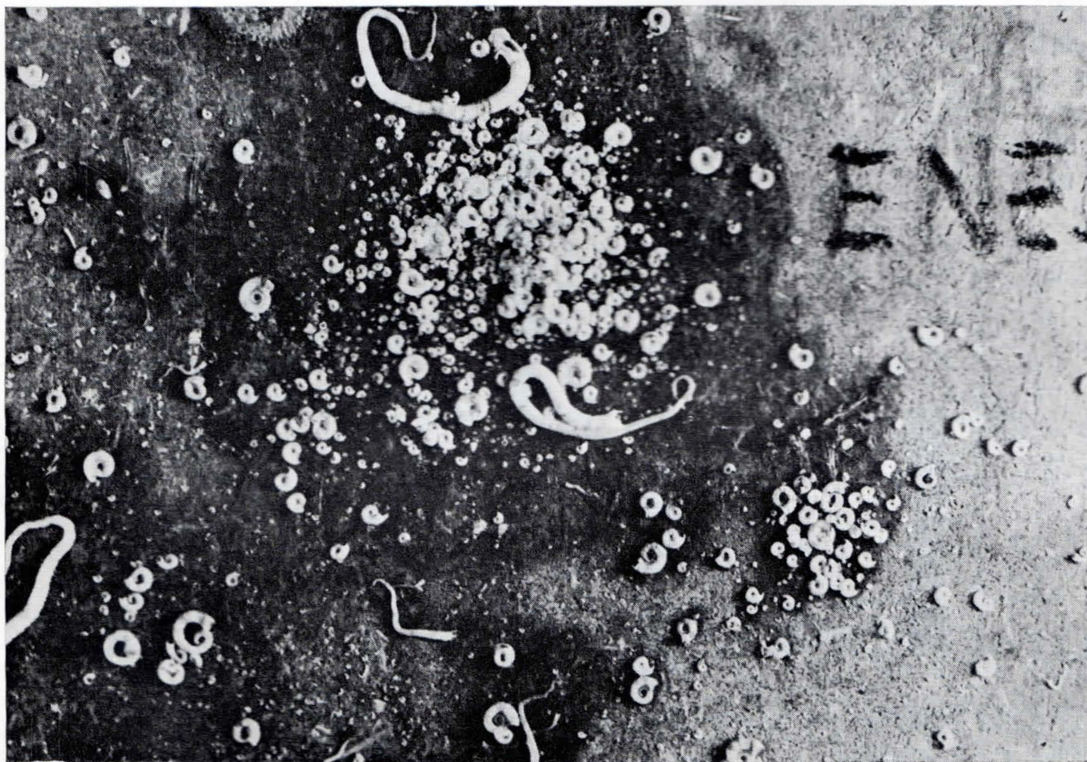
FIG. 16. Pannello immerso per 3 mesi, dal 28 gennaio al 30 aprile 1970 alla stazione n. 5 (ENEL). Si notano Spirorbis insediati a gruppetti: questa disposizione è probabilmente in rapporto al moto vorticoso dell'acqua. È pure bene evidente un modesto insediamento di individui notevolmente accresciuti appartenenti alle specie Hydroides elegans e Serpula concharum .
