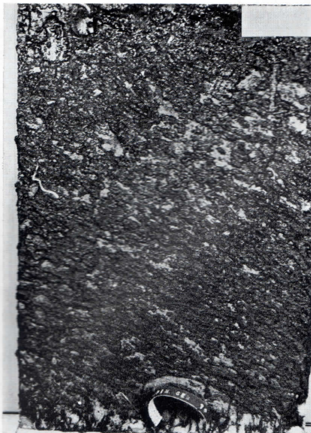
FIG. 9. Pannello immerso per 6 mesi, dal 28 luglio 1969 al 30 gennaio 1970, alla stazione n. 1 (Spinola). Si osserva uno strato di fanghiglia e Alghe; sul margine sinistro del pannello è visibile l'unico Serpulide insediato.
