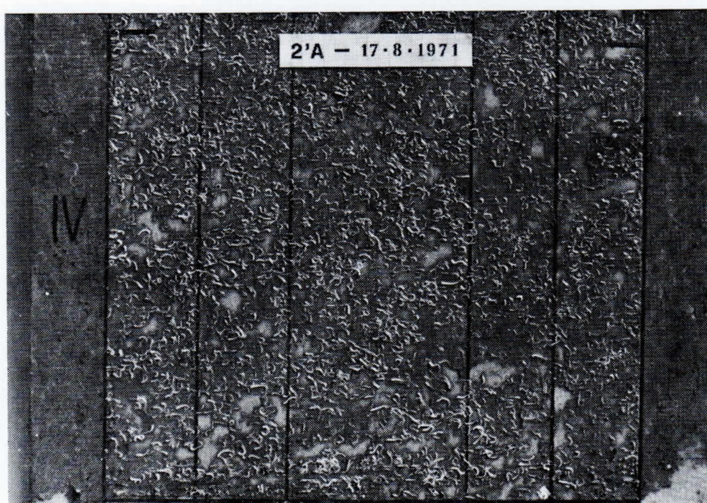
FIG. 10. Pannello del secondo settore (Fig. 6) sottoposto per una settimana ad un flusso d'acqua con velocità pari a 2,5 m/sec.
