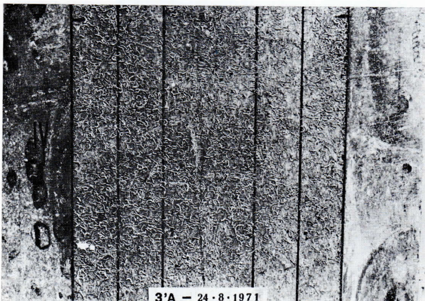
FIG. 15. Pannello del terzo settore (Fig. 7 e 11) dopo due settimane di permanenza nella condotta (velocità 3,12 m/sec.).
