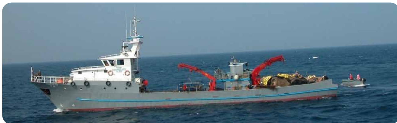
Fig. 10 - Nave speciale per tonnara volante ( purse-seine ) munita di power block .
