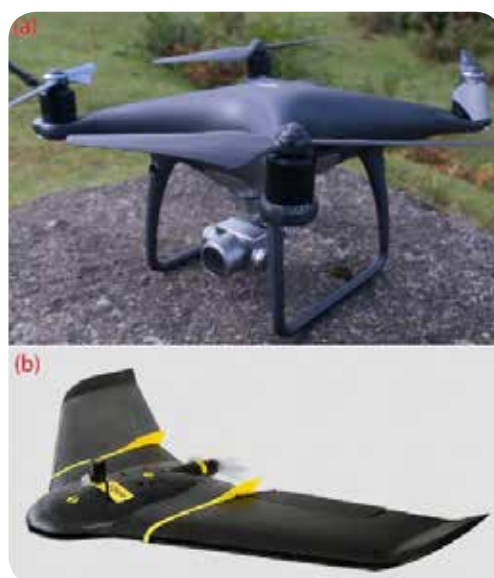
Fig. 4 - I droni sono diventati strumenti sempre più utilizzati per la mappatura degli habitat costieri in quanto capaci di raccogliere immagini aeree ad altissima risoluzione con costi contenuti. a) Drone multi-rotore; b) drone ad ala fissa.
