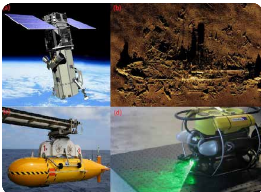
Fig. 3 - Nuovi alleati per le indagini dell'ambiente marino e la mappatura degli habitat bentonici. a) Immagini ad alta risoluzione spaziale, spettrale e temporale disponibili grazie ai sistemi satellitari World View-3; b) Sonogramma ad altissima risoluzione di un relitto acquisito mediante sonar ad apertura sintetica (SAR); c) veicolo autonomo subacqueo (AUV) munito di ecoscandaglio multifascio; d) veicolo pilotato da remoto (ROV) con laser scanner per rilievi 3D di precisione.
