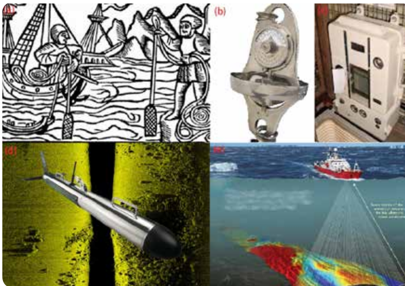
Fig. 2 - Evoluzione storica degli strumenti per l'indagine dei fondali marini. a) Cime piombate graduate utilizzate per conoscere le profondità dei tratti navigabili già agli albori dell'arte marinaresca (illustrazione tratta da Olaus Magnus, "Historia om de nordiskafolken", 1555); b) profundimetro ideato da Edward Massey (1802); c) primo ecoscandaglio a fascio singolo ( Single Beam ) ideato da Alexander Behm (1913); d) Side Scan Sonar (SSS); e) ecoscandaglio multi-fascio ( Multi Beam Echo Sounder - MBES) sviluppati durante il periodo 1960-70.
